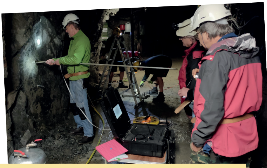
Ve štolě Josef se testovalo měřicí zařízení pro charakterizaci EDZ
